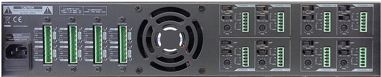
Auf der Rückseite befinden sich paarweise symmetrierte Eingänge, HPF-Filter (-3dB/180Hz), Umschalter für die Betriebsart und ein Volumenregler. Der Anschluss für die Lautsprecher für den ELA/100V- oder 4/8 Ohm Betrieb erfolgt über EUROBLOCK-Terminals. Die Endstufe ist in einem stabilen, schwarzen 19"/2HE Gehäuse mit Frontgriffen untergebracht.
