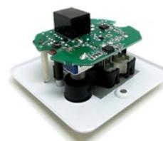
Spannungsversorgung und Audioübertragung WP1 zu Zentrale erfolgt über ein einzelnes Ethernet-Kabel. Weitere Verbindungen und Einstellungen sind nicht nötig!
