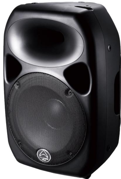
Le haut-parleur actif Titan 8A MKII est équipé de deux amplis de puissance de classe D séparés et délivre une impressionnante puissance de 150W/Sinus au woofer et de 30W/Sinus aux médiums/aiguës. Ainsi, le système de haut-parleurs a une puissance totale de 180W/sinus, de 360W en crête et une pression acoustique max. de 119dB SPL.
