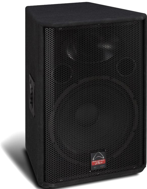
Das Lautsprechersystem verfügt über einen 1.75" Zoll-Hochton-Titanium-Kompressionstreiber und einem neu konstruierten Elliptischem Wave-Guide-Horn (EWG) mit einem Öffnungswinkel von H90° x V60°. Der 15"/381mm Basslautsprecher ist mit einer doppelt gewickelten 2.5" Zoll-Schwingspule ausgestattet. Ein EQ-Flat/Boost-Schalter +3dB für den HF-Bereich, Überlastschutz (ProTech™-Driver) und LED-Anzeigen auf dem Frontgrill für Signal- und Protectanzeige runden die professionelle Ausstattung ab.
