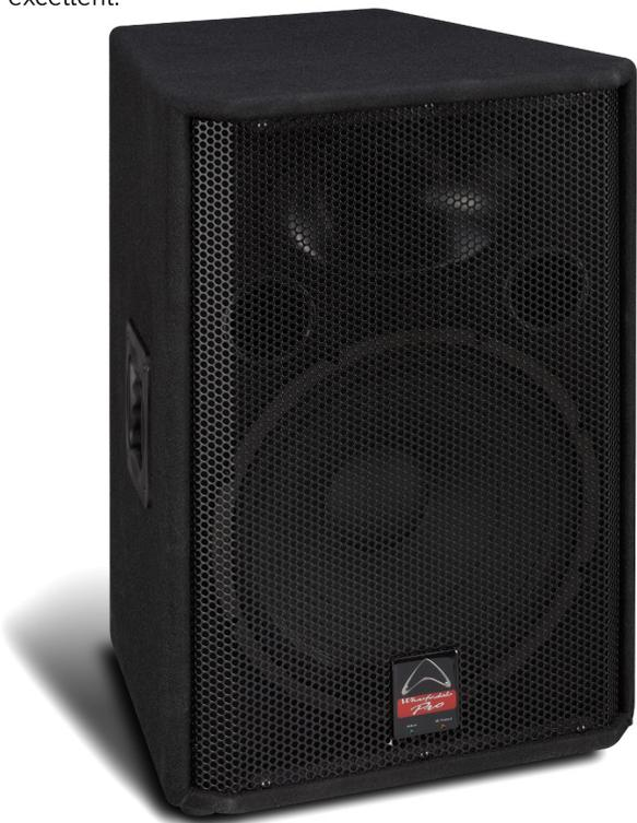
Le système d'enceinte possède un tweeter avec pilote de compression en titane de 1,75" et un Wave-Guide-Horn elliptique nouvellement conçu (EWG) avec un angle d'ouverture de H90° x V60°. Le woofer de 15"/381 mm est équipé d'une double bobine de 2.5". Un commutateur EQ-flat/boost +3 dB pour la gamme HF, une protection contre les surcharges (ProTech™-Driver) et des indicateurs LED sur la grille avant pour l'affichage du signal et de la protection complètent l'équipement professionnel.
