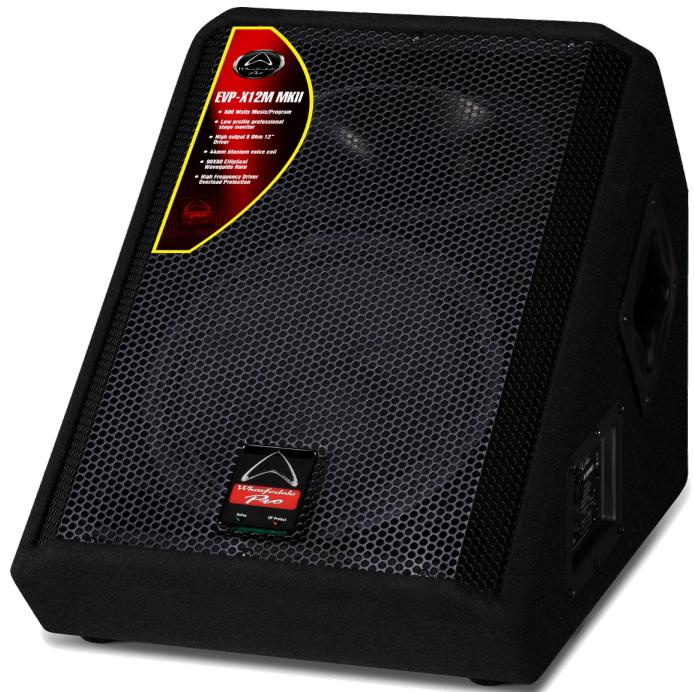
Der Monitor verfügt über einen 1.75" Zoll-Hochton-Titanium-Kompressionstreiber und einem neu konstruierten Elliptischen Wave-Guide-Horn (EWG) mit einem Öffnungswinkel von H90° x V60°. Der 12"/305mm Basslautsprecher ist mit einer doppelt gewickelten 2" Zoll-Schwingspule ausgestattet.
