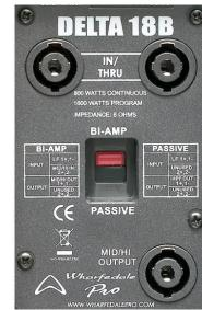
Auf der Rückseite befinden sich drei Speakonbuchsen und der Umschalter für den Passiv/Bi-Amp-Betrieb. Im passiven Betrieb, steht die zweite (IN/THRU) Speakon-Buchse zum Weiterschlaufen an einen weiteren Lautsprecher zur Verfügung.
