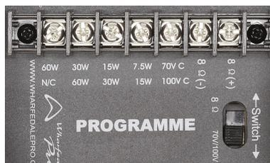
En exploitation Public Address, des prises sont disponibles pour une adaptation à des puissances de 30W, 60W et 120W. Sur le panneau de connexion se trouve le commutateur pour le fonctionnement en 70V/100V et en 8 Ohms.
