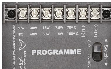
Für den ELA-Betrieb stehen Abgriffe für 30W, 60W und 120W Leistungsanpassung zur Verfügung. Auf dem Anschluss-Panel befindet sich der Umschalter für den 70V/100V und 8-Ohm Betrieb.
