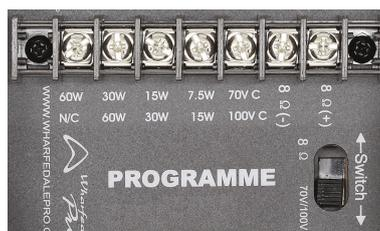
Für den ELA-Betrieb stehen Abgriffe für 20W, 40W und 80W Leistungsanpassung zur Verfügung. Auf dem Anschluss-Panel befindet sich der Umschalter für den 70V/100V und 8-Ohm Betrieb.
