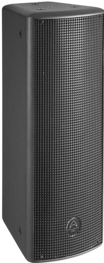
Die Programme 205T von Wharfedale Pro ist ein 2-Weg-Lautsprechersystem bestückt mit zwei 5"-Zoll-Bass-Lautsprechern ( $\varnothing$  12.7cm) und einem HF-Titanium Dome-Tweeter mit  $60^\circ \times 60^\circ$  Abstrahlverhalten. Der Titanium HF-Dome-Tweeter wird mit der pro-tech® PFC-Schutzschaltung gegen Überlastung geschützt. Die Systemleistung beträgt im 8-Ohm Betrieb 100W/Sinus, 200W/Musik und 400W/Peak bei einem max. Schalldruckpegel von 117dB SPL.
