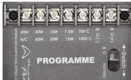
En exploitation Public Address, des prises sont disponibles pour une adaptation à des puissances de 20W, 40W et 80W. Sur le panneau de connexion se trouve le commutateur pour le fonctionnement en 70V/100V et en 8 Ohms. La connexion des enceintes se fait par des bornes à vis.
