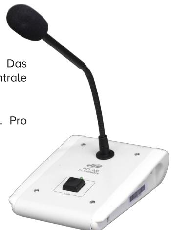
Die Sprechstelle **PTT-200** ist mit zuschaltbarer Gong- und Prioritäts-Funktion ausgestattet. Das Tischmikrofon wird mittels RJ45/Cat.5 Verbindung am Eingangskanal 1 (PTT-200) mit der Zentrale verbunden.
