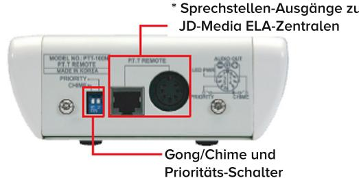
Die **JD-MEDIA PTT-200** Sprechstelle ist mit zuschaltbarer Gong- und Prioritäts-Funktion ausgestattet. Das Tischmikrofon wird mittels Cat.5 Ethernetkabel am PTT-Eingangskanal der Zentrale verbunden. Bei Betätigung der "Talk"-Taste wird die Durchsage in alle Zonen gleichzeitig übertragen. Pro Zentrale können **drei PTT-200 Sprechstellen** bis 250m Distanz angeschlossen werden.
