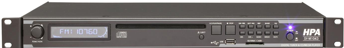
L'appareil offre la possibilité grâce aux 2 sorties séparées stéréo fixes de connecter simultanément à une sortie le signal tuner FM et à l'autre sortie le signal audio à partir d'un CD ou d'une carte USB/SD/MMC. Ainsi le lecteur multimédia HPA SY-M 1043 permet, par exemple dans un système multizone, la reproduction à partir de sources audio séparés! A la sortie variable, dépendant du régulateur de volume, se trouvent à disposition toutes les sources audio.
