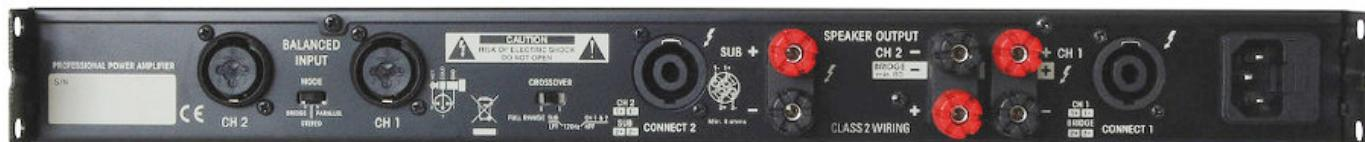
Für die Eingangs-Signale stehen symmetrierte Combo XLR/F-Stereojack-Buchsen zur Verfügung. Auf der Front befinden sich der Powerschalter, Volumenregler und LED-Statusanzeigen für Signal-, Clip und Protect. Die Endstufe kann im Stereo-, Paralell- oder Bridge-Mode betrieben werden. Die Minimum-Impedanz beträgt im Stereo-Betrieb 4 Ohm, im Bridgemode 8 Ohm.
