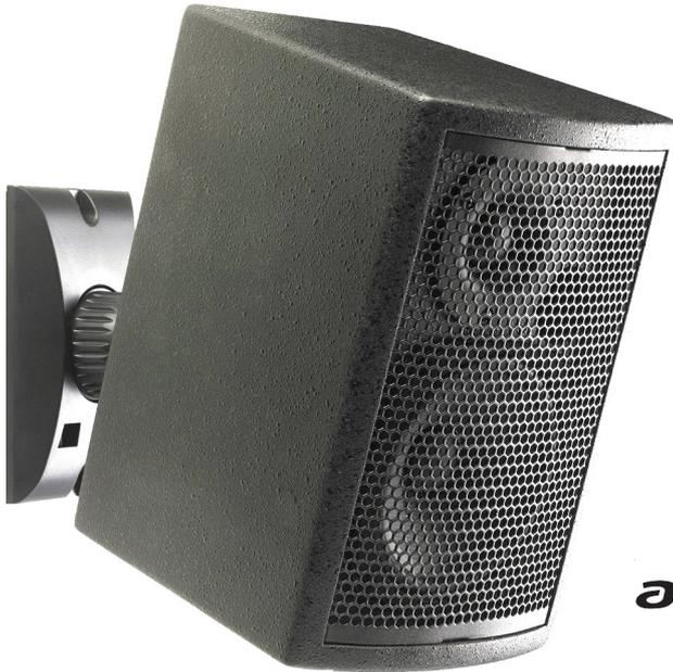
Le système est équipé d'un woofer 4"/10 cm et d'un tweeter à compression 1", d'une puissance de 40W/RMS jusqu'à 80W max. sous 8 Ohms.
