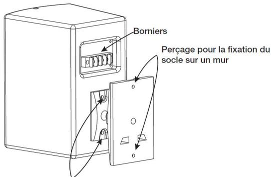
Perçage pour la fixation du socle sur le satellite
