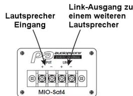
Anschlussfeld mit Schraubklemmen für den Anschluss des Lautspechers und ein Link-Ausgang zu einem weiteren System.
