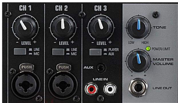
Le mixer à 3 canaux est équipé d'un contrôle de niveau et d'un commutateur micro/ligne sur chaque canal pour les sources audio. Le canal 3 peut être commuté à partir du mode Player (lecteur SD/USB, Bluetooth®) sur AUX. Il y a 2 prises RCA pour la connexion de lecteur CD/MP3, tuner, tablette, radio web ou PC.
