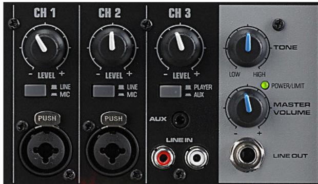
Der 3-Kanal Mixer verfügt pro Kanal über Pegelkontrolle und Mic/Line-Umschalter für die Audioquellen. Kanal 3 kann vom Player-Mode (SD/USB-Reader, Bluetooth®) auf AUX umgeschaltet werden. Es stehen 2 Cinchbuchsen zum Anschluss von CD/MP3-Player, Tuner, Tablet, Webradio oder PC zur Verfügung.
